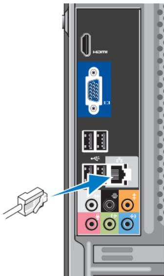
網路連線不是完成電腦安裝的必需程序，但是，如果您具有使用纜線連接 (例如家用纜線數據機或乙太網路插孔) 的現有網路或網際網路連線，則可以立即連線到網路。請僅使用乙太網路纜線 (RJ45 連接器)。請勿將電話線 (RJ11 連接器) 插入網路連接器。
